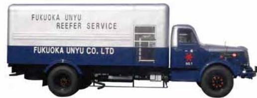
国産第一号機械式冷凍車(矢野式冷凍車)
